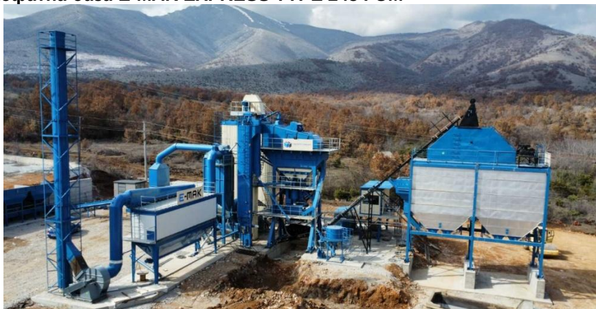
Слика II-3. Асфалтна база E-MAK EXPRESS TYPE 245 FUM
