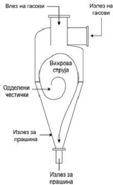
Слика II-59. Пресек на пред пречистувач/сепаратор на гасови/скруббер
