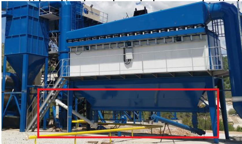
Слика II-42. Систем од филтер, спирални транспортери и елеватор за дозирање на филер
