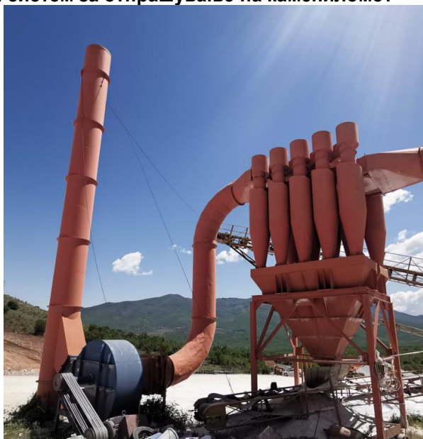
Слика II-19. Циклонски систем за отпрашување на камениломот
