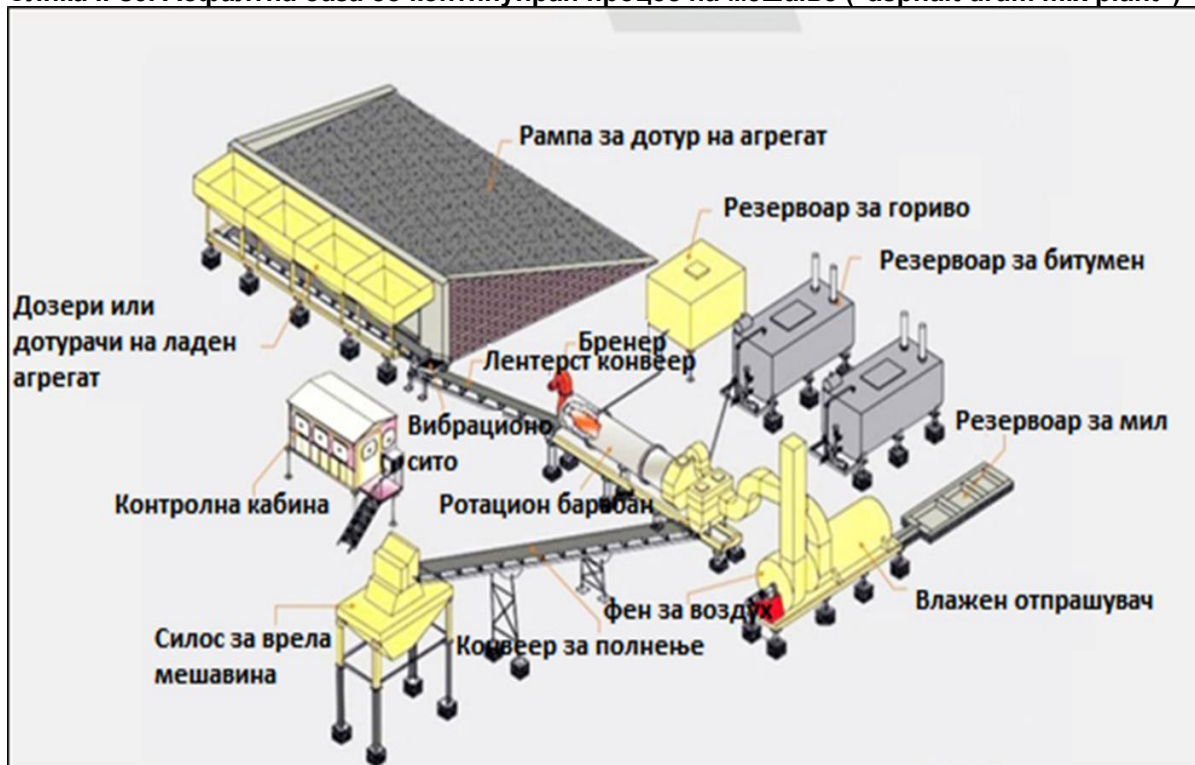
Слика II-30. Асфалтна база со континуиран процес на мешање (“asphalt drum mix plant”)
