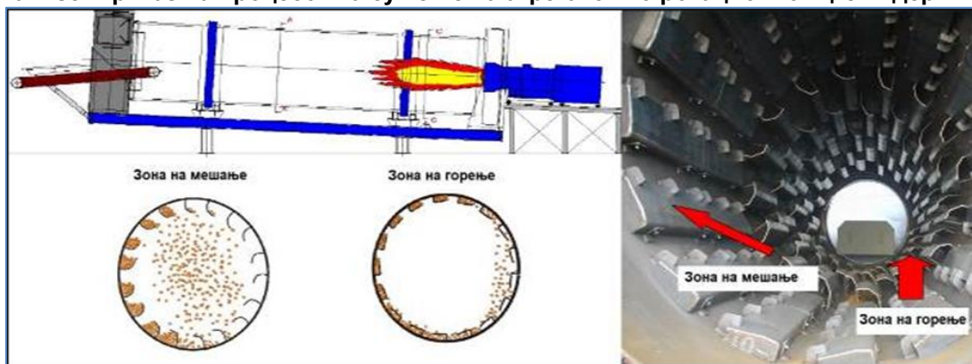
Слика II-36. Приказ на процесот на сушење на агрегатот во ротациониот цилиндер
