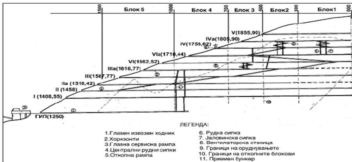
Надолжен пресек на рудникот, со поделба на поткоп-хоризонти и откопни блокови
