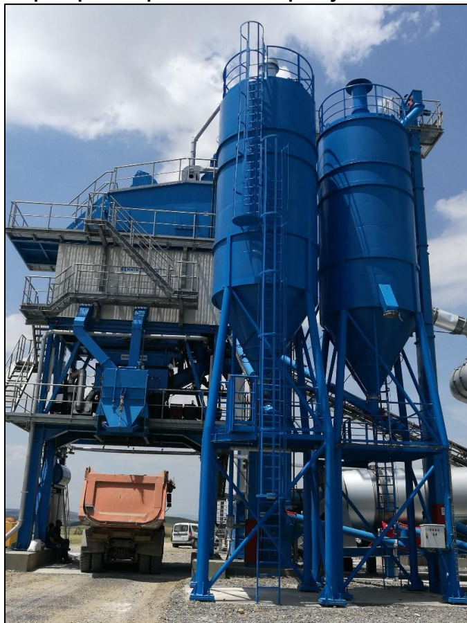
Слика II-21. Силоси за филер со кофичест елеватор и кула за мешање
