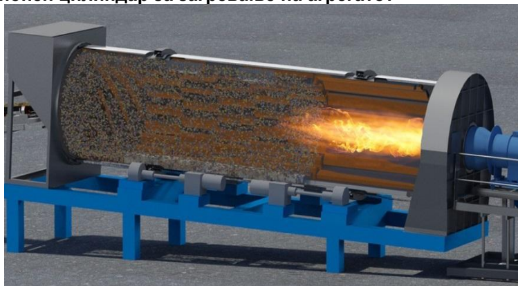
Слика II-9. Ротационен цилиндар за загревање на агрегатот
