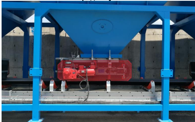
Слика II-8. Собирна лента со систем за придвижување
