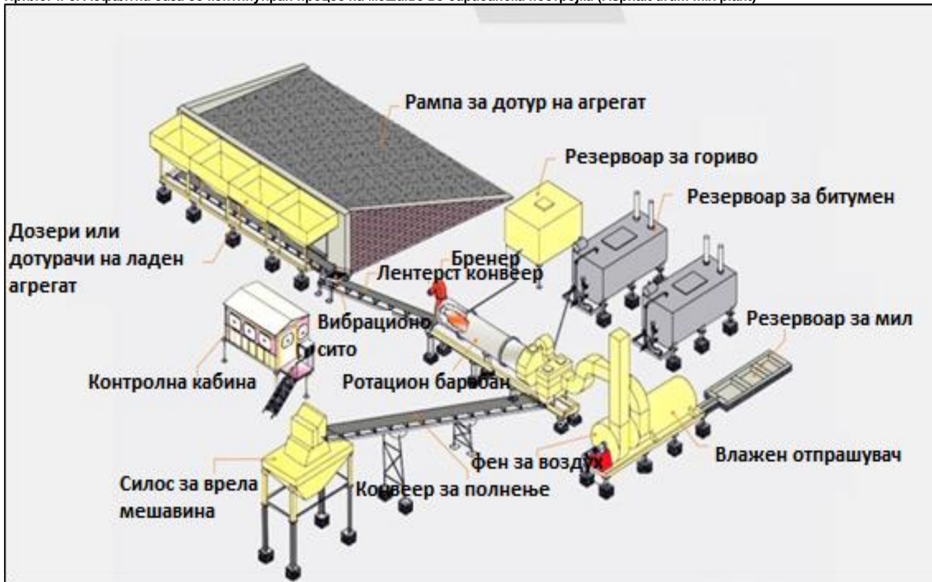
Прилог II-6. Асфалтна база со континуиран процес на мешање во барабанска постројка (Asphalt drum mix plant)
