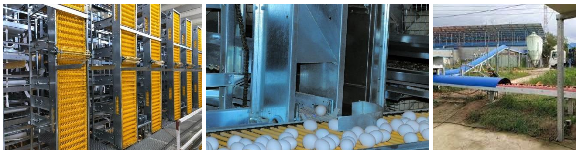
Слика 51 Систем за транспортирање на јајцата од лево кон десно: лифтови, внатрешен и надворешен транспортер за јајца
