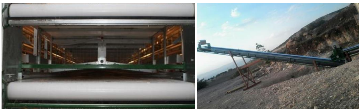
Слика 39 Внатрешни транспортни ленти за одведување на екскретот (изгубрување) (лево) и надворешен транспортер (десно)
