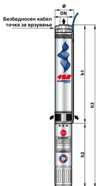
Слика 35 Изглед на водната пумпа и нејзина поставеност во бунарот
