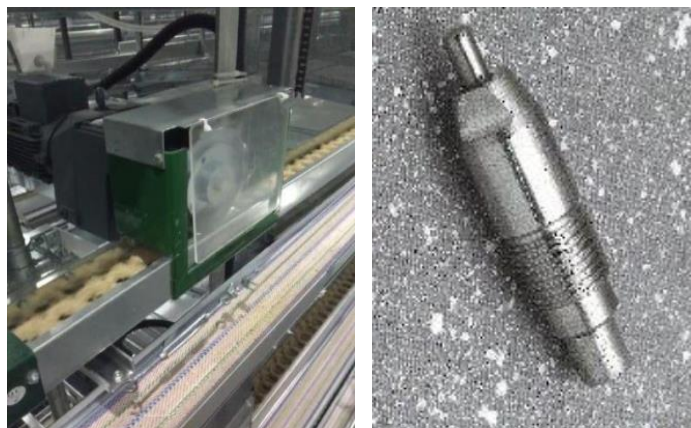
Слика 38 Линиски транспортен систем за хранење на живината (лево) и изглед на нипла за поење (десно)
