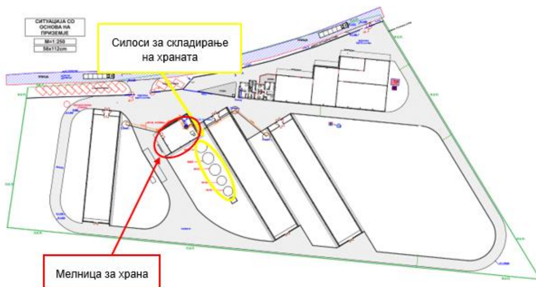
Слика 20 Поставеност на мелницата со силосите (пет) за привремено складирање на храната за живината и системите за доставување на храна до другите објекти
