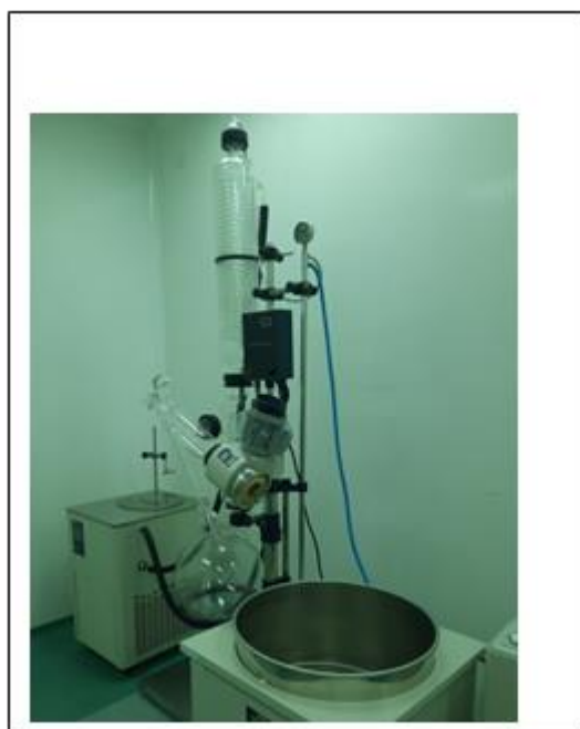
Слика бр. II-7: Процес на евапорација
