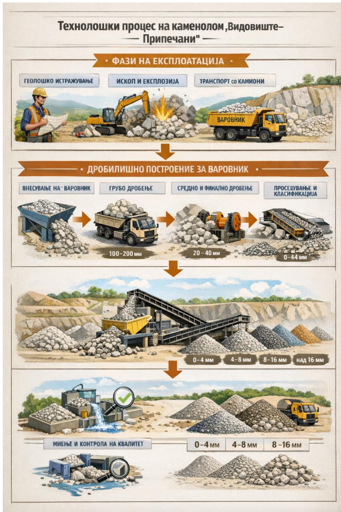
Слика II.1-2. Технолошки процес на каменоломот
