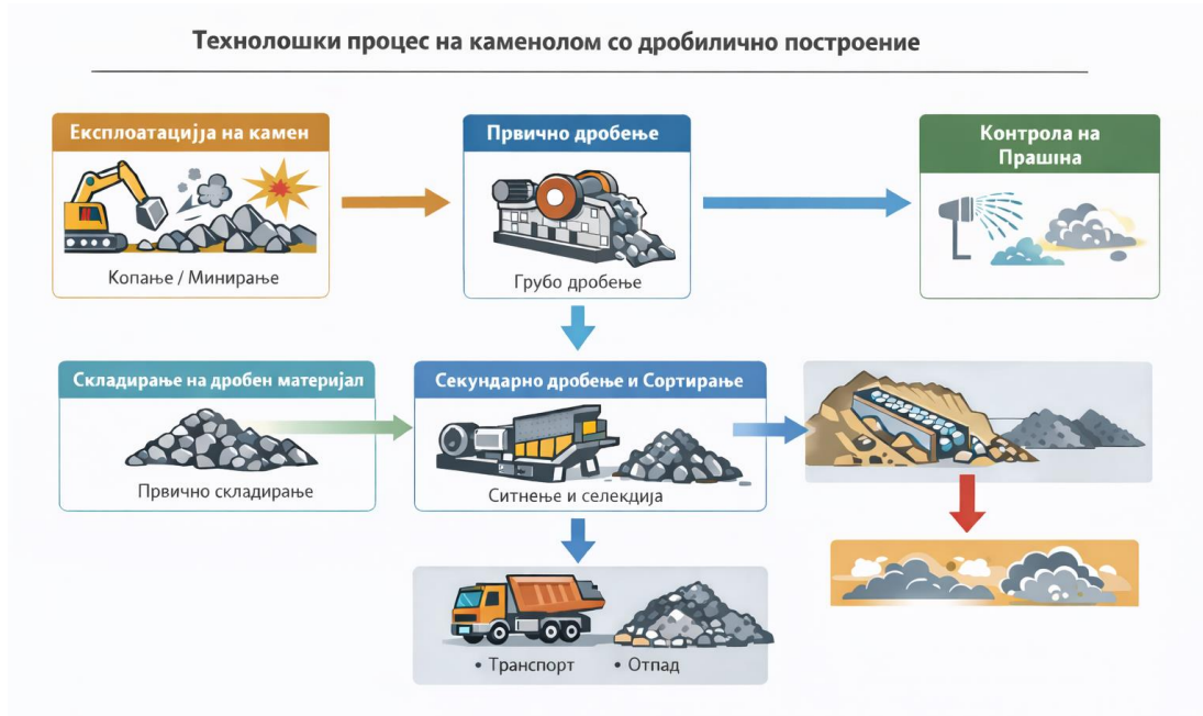
Слика бр. II.11. Шема на технолошки процес на каменоломот
