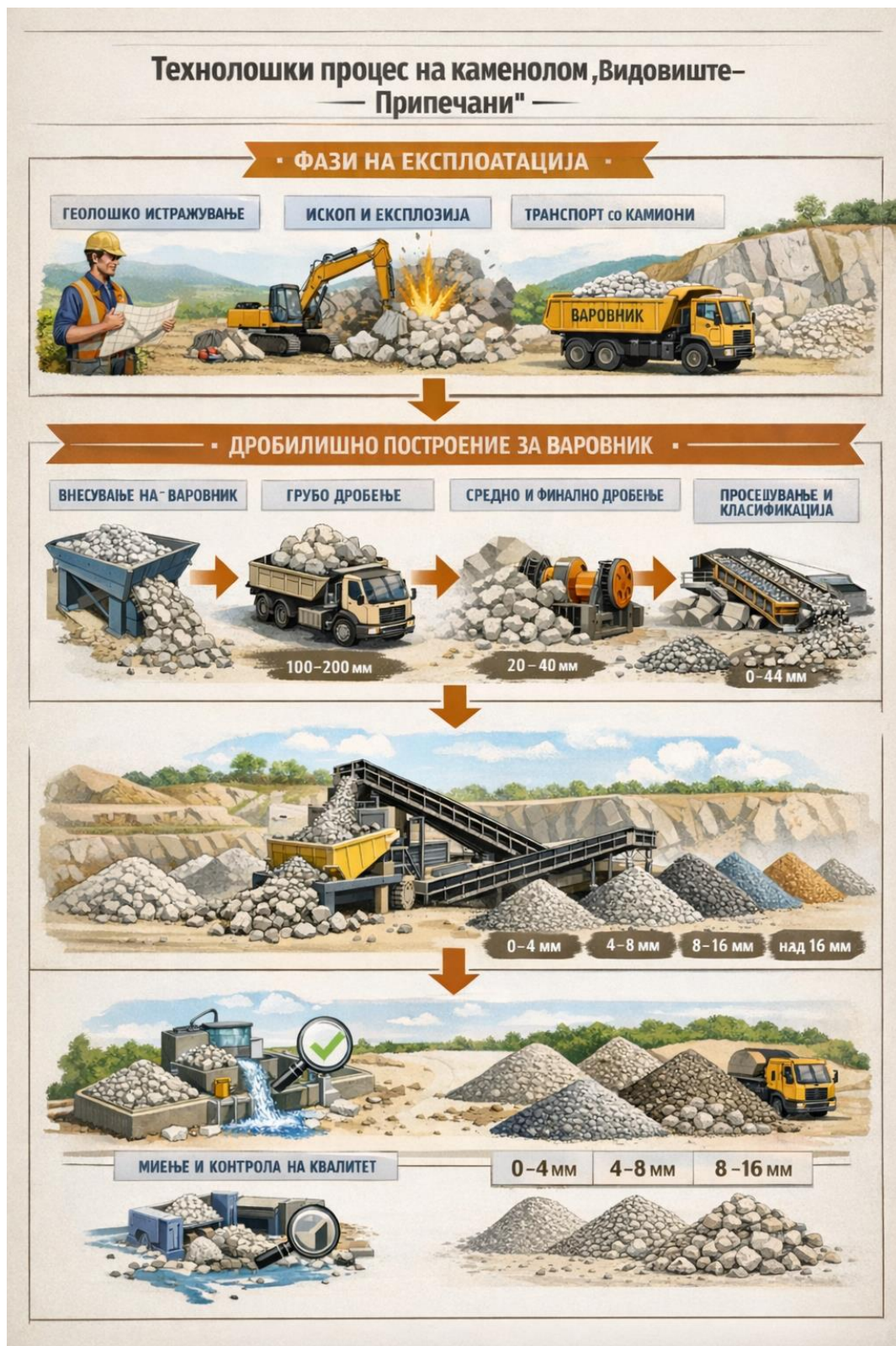
Слика II.7. Технолошки процес на работа на каменоломот и сепарацијата
