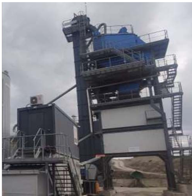
Елеватор, сито, бункери, контролна кабина контејне
