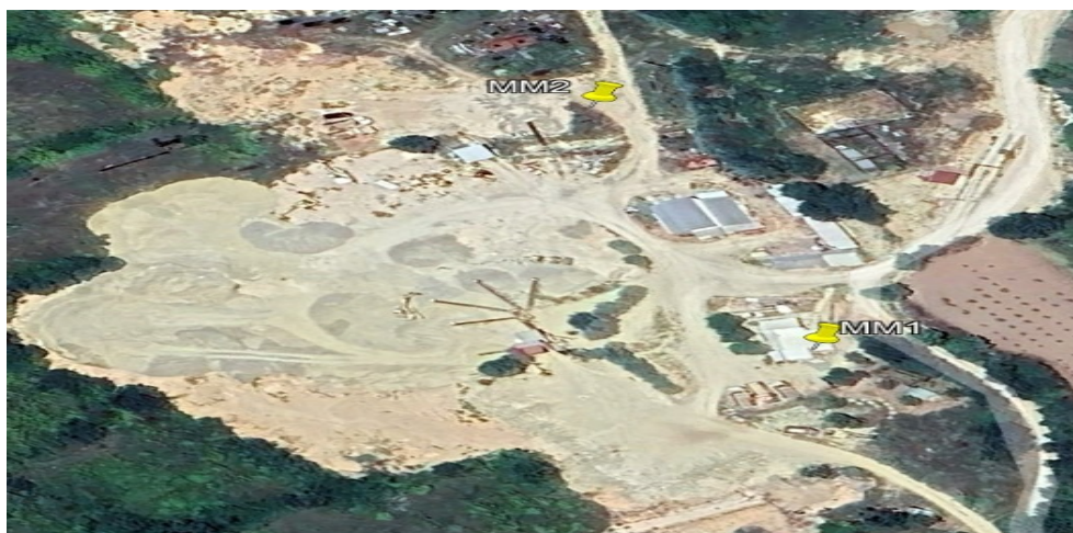
Сл. Точки на земање примерци за одредување на квалитетот на амбиентен воздух, односно масена фракција на суспендирани честички ЦЧ10 (PM10), во околина на инсталацијата, точки ММ1 и ММ2
