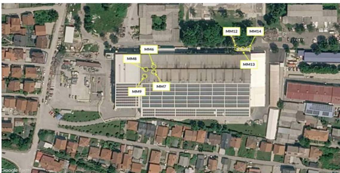
Слика: Емисиони точки во воздух од топење на алуминиумски легури, леење и од пескарење
