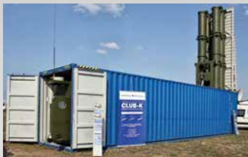
Слика 2: Универзален лансиран контејнер за крстосувачките ракети во позиција за дејство
