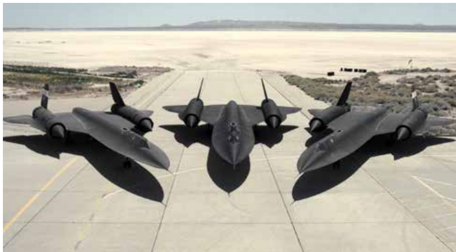
Avioni „Lockheed SR-71 „Blackbird“ është një avion strategjik zbulimi me rreze të shkëlqyer, i destinuar për fluturime në lartësi të mëdha dhe me shpejtësi 3+ max
