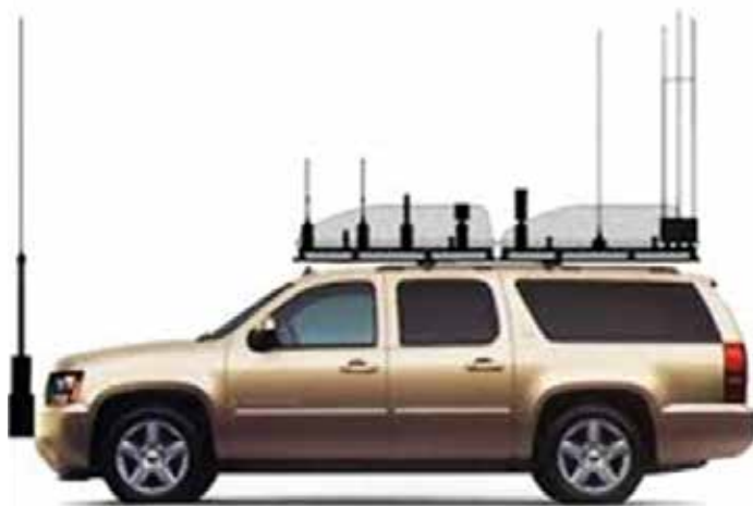
Слика 5. Возило со RCIED-попречувач – прикажува воено возило опремено со попречувач
