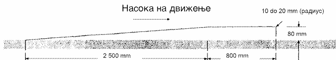
Слика 1 Препрека за испитување на потпирањето
