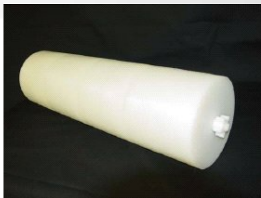
Фантом за мерење на расеана фракција, загубени импулси и случајни коинциденции
