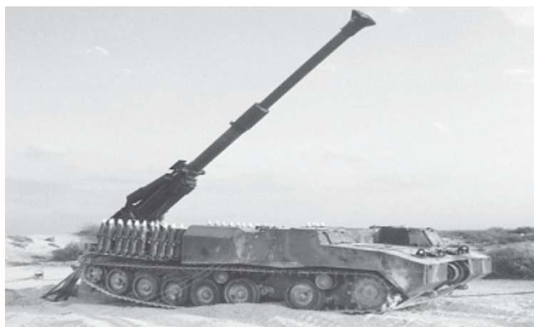
Сл. 6 Израелска лесна самоодна хаубица „Раскал“ од 155 mm, малајќа големина и маса од 18 t дозволува авиоитранспорти со Ц-130.
