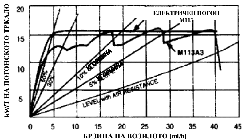
Сл. 7. Споредба на механичка кај м/в HAMWWE M113A3 со електрична трансмисија кај м/в HAMWWE M113 при исти мотор со иста расположива моќност
