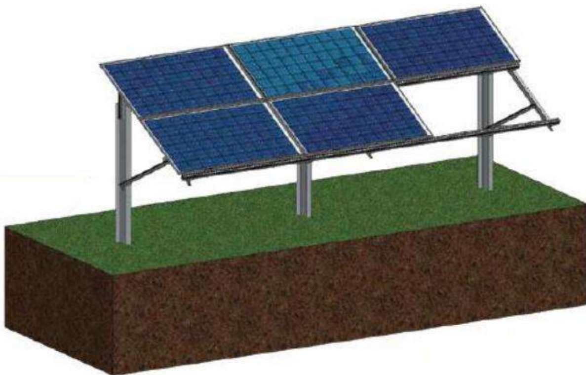
Слика 10. Приказ на монтажната конструкција
